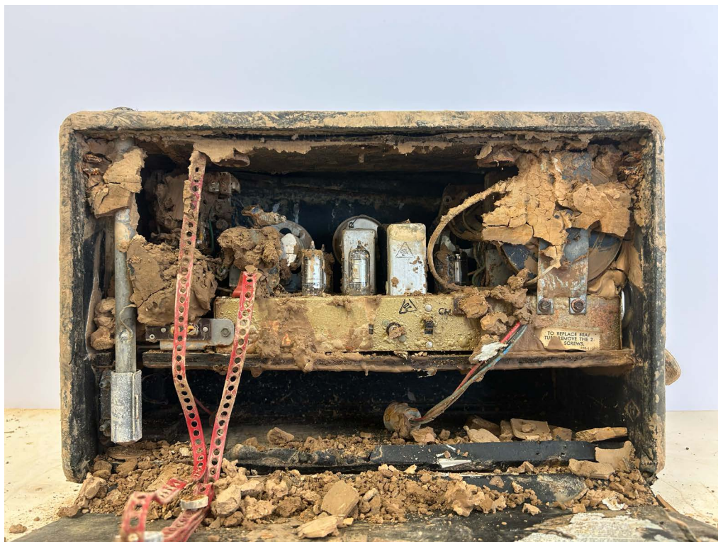
Figura 7. Interior de una radio afectada por la DANA.
