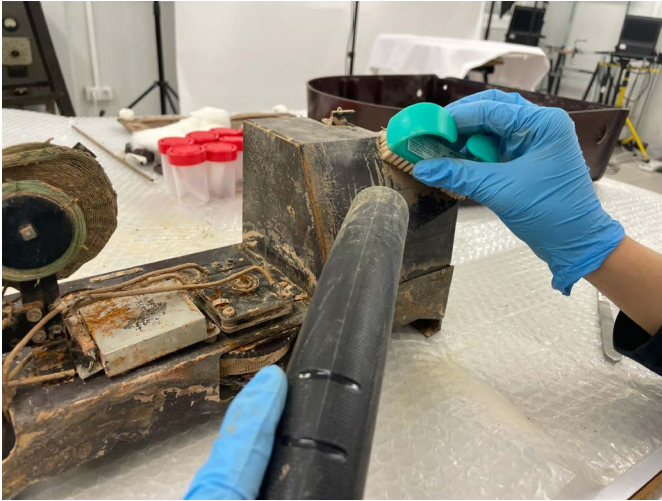
Figura 11a. Proceso de limpieza del interior de un aparato radiofónico por componentes.
