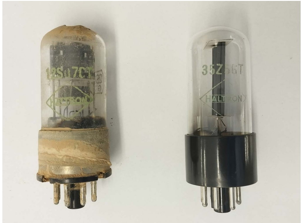
Figura 12. Válvulas de uno de los aparatos radiofónicos antes y después del proceso de restauración.
