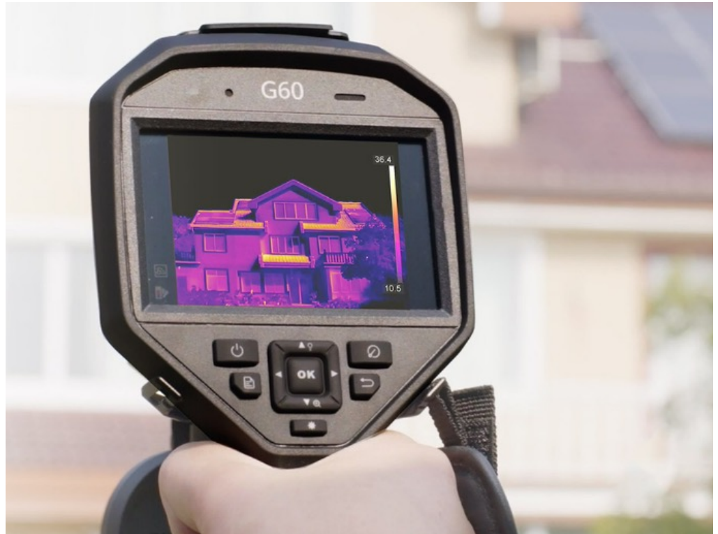
Figuras 23. Uso de una cámara termográfica portátil durante la inspección de un edificio.
